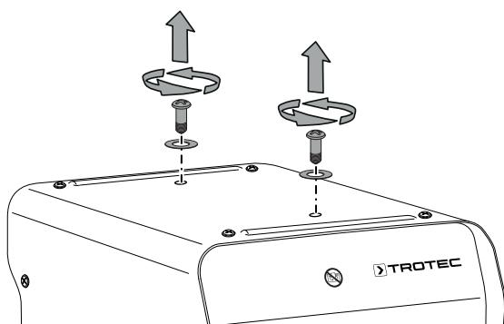
2. Ručku za transport montirajte vijcima i podložnim pločicama.
