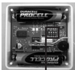
b) Platine du radio-capteur
