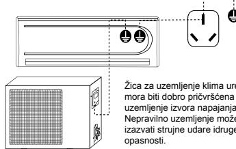
Žica za uzemljenje klima uređaja mora biti dobro pričvršćena za uzemljenje izvora napajanja. Nepravilno uzemljenje može izazvati strujne udare i druge opasnosti.
