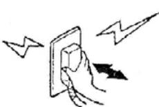
Takov postupak može izazvati strujni udar i izazvati požar.
