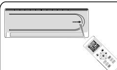
Svaki put kad neka tipka na daljinskom upravljaču bude pritisнута, a on je usmjerena prema klima uređaju, šalje se signal. Kad je signal pravilno primljen, oglasi se zvuk iz klima uređaja koji potvrđuje prijem signala.
