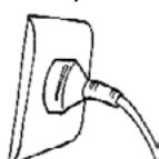
Ukoliko na utikaču ima prašine ili nije pravilno spojen, može doći do strujnog udara ili požara.
